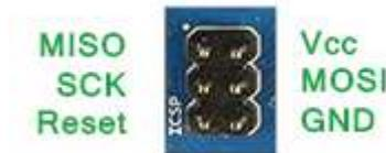
**Figure 7 - Connecteur ICSP (carte Arduino MEGA 2560)**
