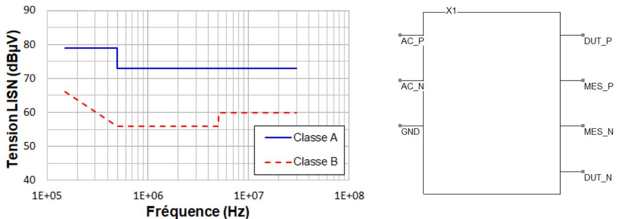
Limite d'émission conduite définie par le standard EN55022 (à gauche) et symbole du modèle du RSIL utilisé dans le bureau d'étude
