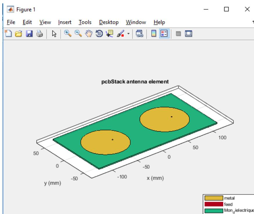
Fig. 5 – Réseau de deux antennes patch circulaires modélisé à l'aide de la fonction pcbstack
