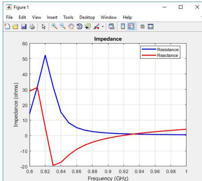
Fig. 3 - Impédance d'entrée d'une antenne patch circulaire
