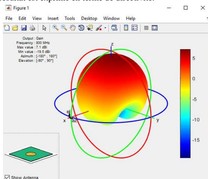
Fig. 4 - Diagramme de rayonnement d'une antenne patch circulaire
