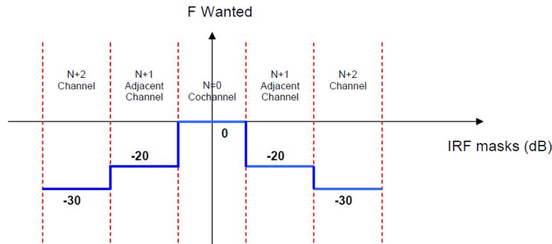
Fig. 11 – Principe du gabarit IRF
